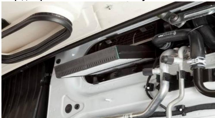
**Высокое качество воздуха благодаря уменьшению количества частиц пыли, поступающих в кабину через систему вентиляции. Снижение затрат, так как фильтр можно часто чистить и, следовательно, его не нужно менять так часто.**
