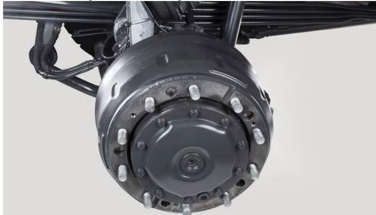
**Высокая безопасность вождения благодаря хорошим значениям торможения при всех рабочих условиях. Защита от повреждения компонентов тормозов из-за загрязнения, сыпучих грузов и т. д. Закрытая конструкция предотвращает попадание посторонних предметов.**
