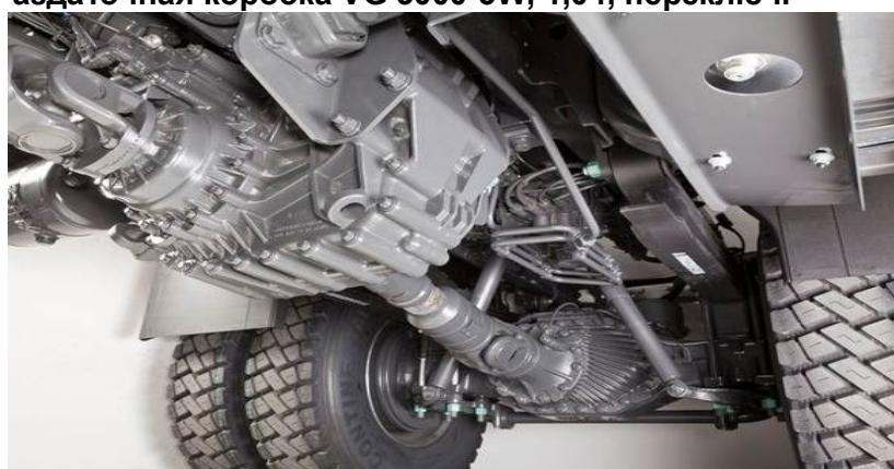
Коробка передач VG 3000 распределяет мощность приводного вала на переднюю и заднюю оси (оси) через блокировку дифференциала между осями в соотношении 1: 1 с включенным приводом на передние колеса.
