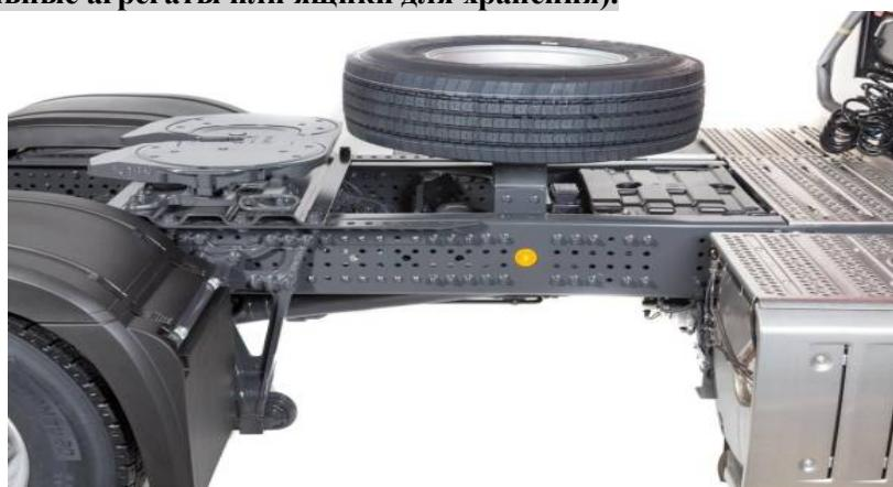
**C7T Компоновка агрегатов в заднем свесе рамы**
