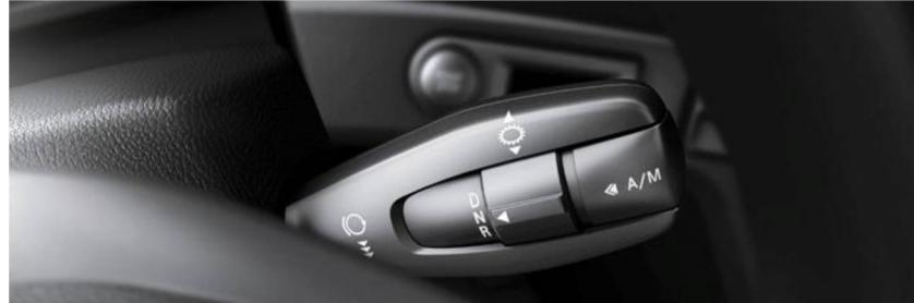
Коробка передач G 330-12 представляет собой автоматическую коробку передач с прямым приводом с 12 передними передачами и 4 задними передачами.
