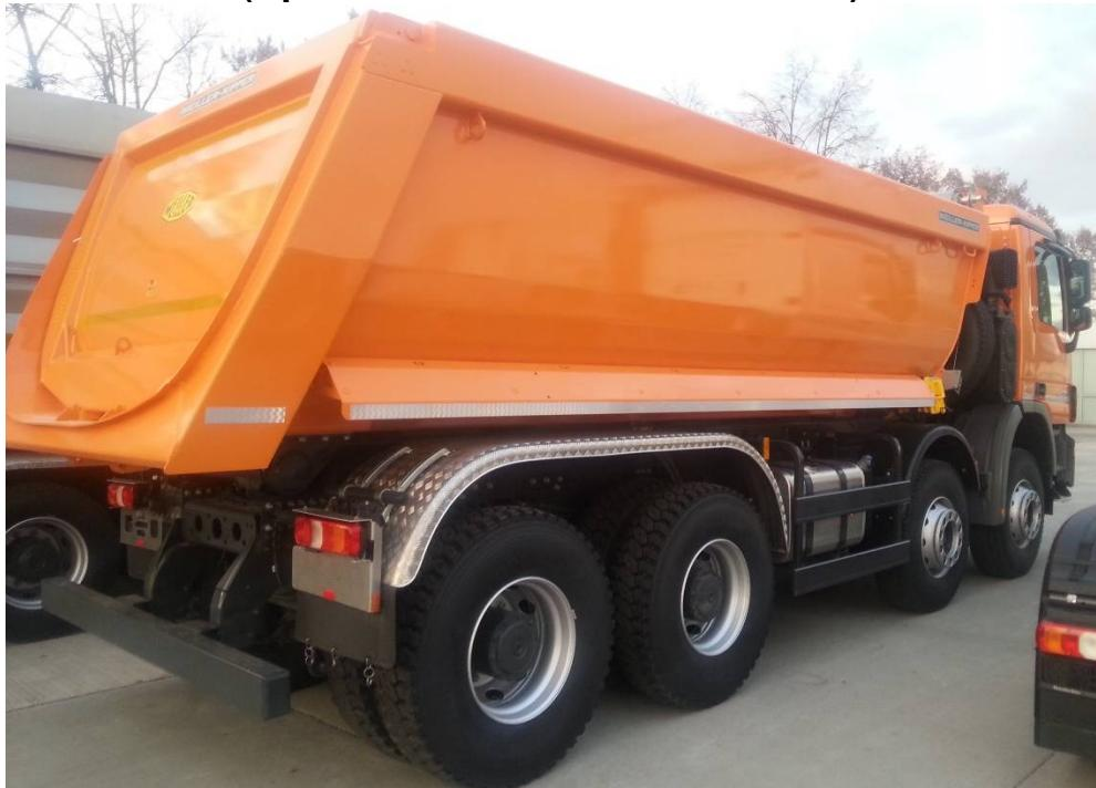
Размеры самосвального кузова: 5,5 x 2.3 x 1.5 м
