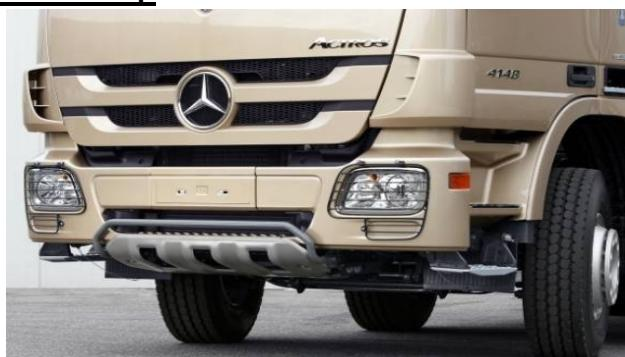
**Снижает риск повреждения автомобиля на строительных площадках и на бездорожье. Снижение стоимости ремонта благодаря конструкции из трех частей.**
